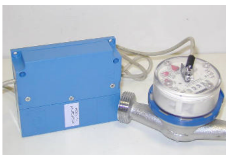
Contatore idrico collegato a un apparecchio di Telelettura (Trasmettitore TX-400 Métron)
