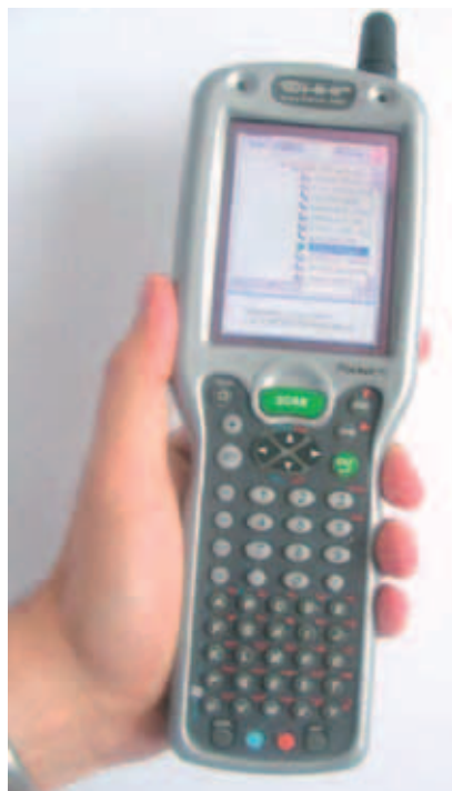
Uno dei terminali utilizzati per la fotolettura dei contatori
